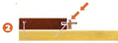
**Stap 2: Montage Deckwise® Clip** Boor boven iedere draagbalk onder een hoek van 45° graden een gat van 1/8"(3,2mm) door de zijkant van de vlonderplank. Plaats een DeckWise® clip in de groef van de vlonderplank waar u hebt voorgeboord. Draai de rvs schroeven onder een hoek van ongeveer 45° graden door het gat in het midden van de DeckWise® clip, door de vlonderplank en in de draagbalk. Monteer iedere vlonderplank met één clip en één schroef per draagbalk.
