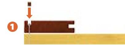
**Primer Paso: Para la instalación del primer tablón** pre-taladre un agujero usando una broca de 1/8"(3,2mm) con un avellanador de 3/8"(9,5mm) para insertar inicialmente los tornillos y tapones. Inserte el tornillo por el agujero piloto y ponga unas cuantas gotas de pegamento en el agujero después inserte los tapones de madera y cuando el pegamento haya secado, remueva el exceso del tapón con un cincel filudo o con una sierra. Después, use una lijadora orbital para poder hacerlo liso.
