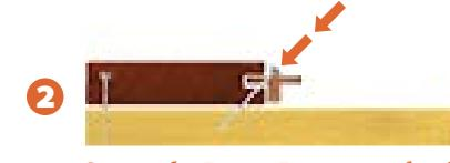
**Segundo Paso: Para instalar las fijaciones DeckWise®** Para instalar las fijaciones DeckWise® por la esquina del primer tablón, perfore un agujero piloto con una broca de 1/8"(3,2mm) a un ángulo de 45° grados a través del tablón encima cada vigueta. Introduzca los tornillos de acero inoxidable a un angulo de 45° grados por el agujero en el centro del fijacion Deckwise® pasando el tablón y siguiendo hasta la vigueta. Asegure cada tablón usando un tornillo y un fijación por cada vigueta.
